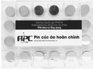
Pin cúc áo từ vỏ trấu được sản xuất thử nghiệm. Ảnh: Nhóm nghiên cứu
